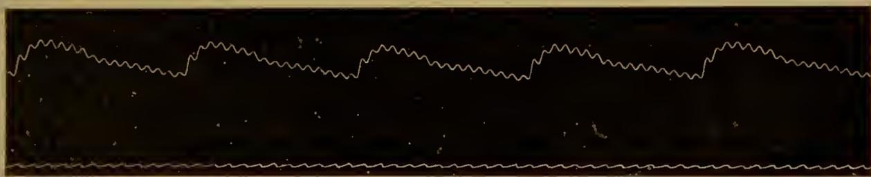
Figur 116. Die Eigenschwingungen bei Franks Hebelmanometer bei der Schreibung des Aortadruckes beim Kaninchen. Die Stimmgabelschwingungen geben  $\frac{1}{50}$  Sek. an. Die Schwingungszahl des Manometers beträgt hier etwa 72 pro Sekunde.
